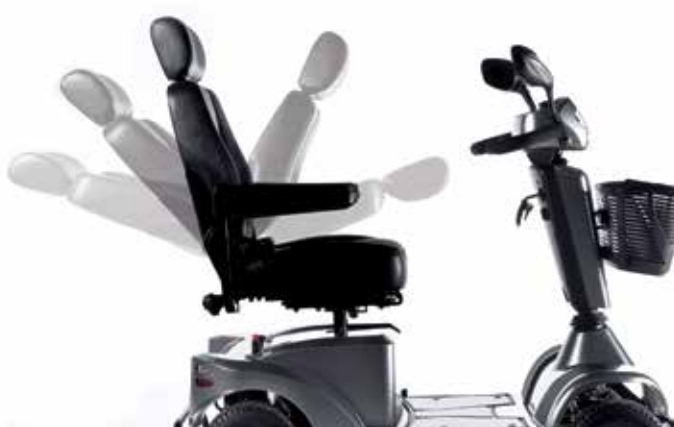
→ Pratico meccanismo per la reclinazione dello schienale
